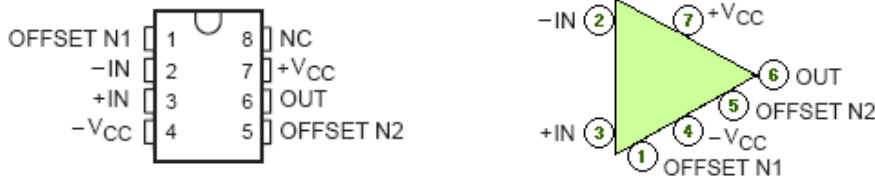
Şekil 14. UA741CN ve µA741C Op-Amp entegrelerinin bacak bağlantıları
