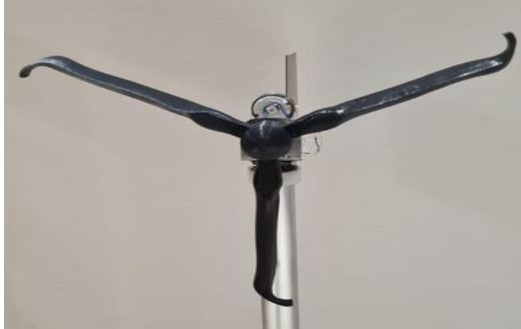
Şekil – 6: Rüzgar Türbininde Winglet Kullanımı
