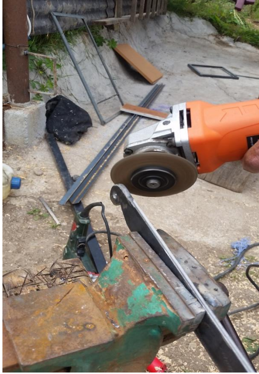
Şekil 2. Manivela Kolu Taşlama İşlemi
