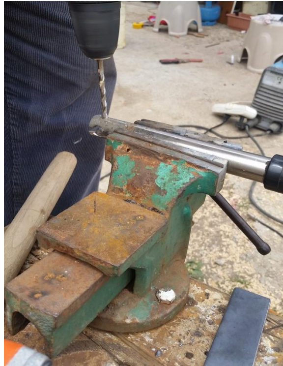
Şekil 5. Motor Pimi Delme İşlemi
