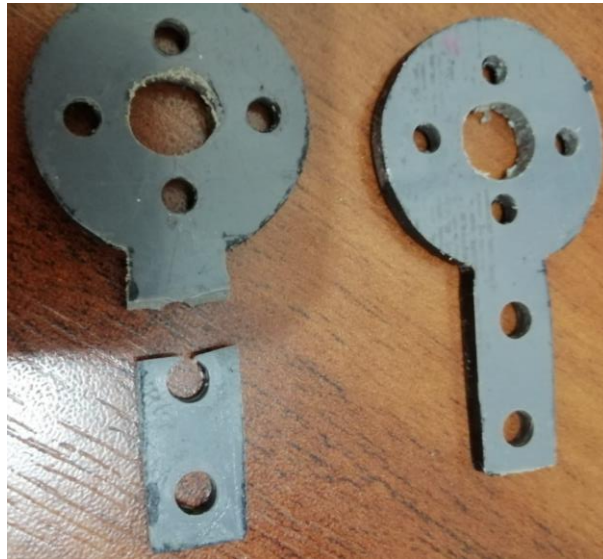
Şekil 64. Kırılan motor taşıyıcı plakası
