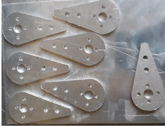
Şekil 65. Yeni tasarımla imal edilen motor taşıyıcı plakalar
