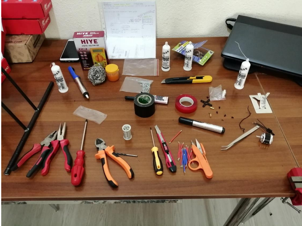
Şekil 43. Montaj sırasında kullanılacak ekipmanlar: Pense, tornavida, maket bıçağı, elektrik bandı, konnektörler, yapıştırıcılar vs.
