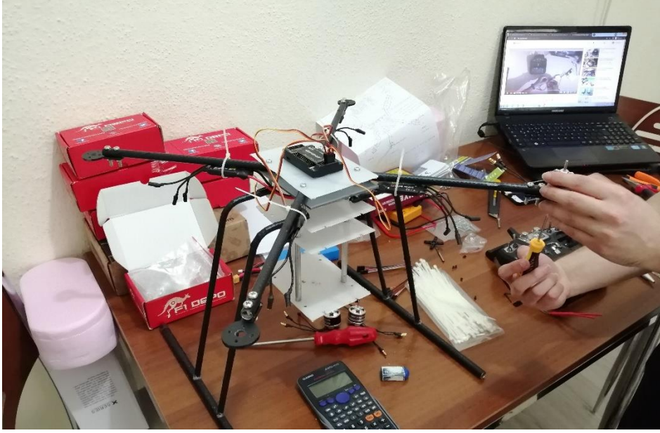
Şekil 54. Uçuş kontrol kartının gövdeye monte edilmesi, ESC'lerin kollara kablo bağları ile sabitlenmesi ve konnektör bağlantısı yapılmış motorların motor tutucularına montaj aşaması
