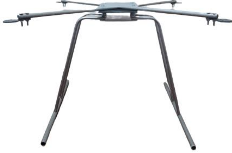
Şekil 46. İniş takımının plaka altına montajı
