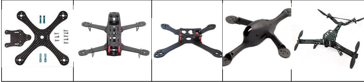
Şekil 6. Sırası ile X Tipi Gövde, H Tipi Gövde, Sıkıştırılmış X Tipi Gövde, + (Artı) Tipi Gövde ve V-Kuyruk Tipi Gövde [33 , 33 , 33 , 34 , 35]
