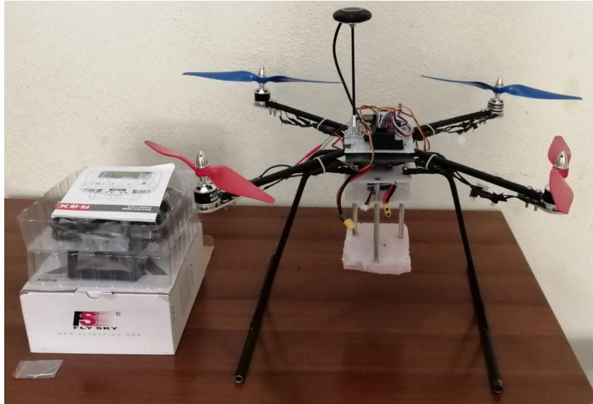
Şekil 66. Yeni tasarımla imal edilen motor taşıyıcı plakaların montajı
