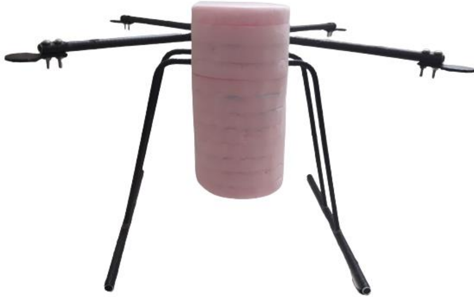
Şekil 49. Üst kapağın da birleştirilmesiyle tamamlanmış olan gövde montajı
