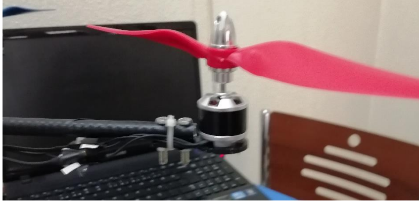
Şekil 59. Pervanelerin motorlara montajı
