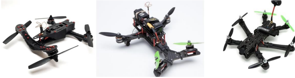
Şekil 8. İnsansız hava aracının iskeleti (gövdesi) [22]
