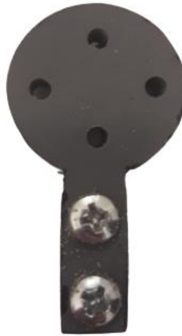
Şekil 21. Motor ile kol arasındaki bağlantıyı sağlayacak olan bağlantı plakası
