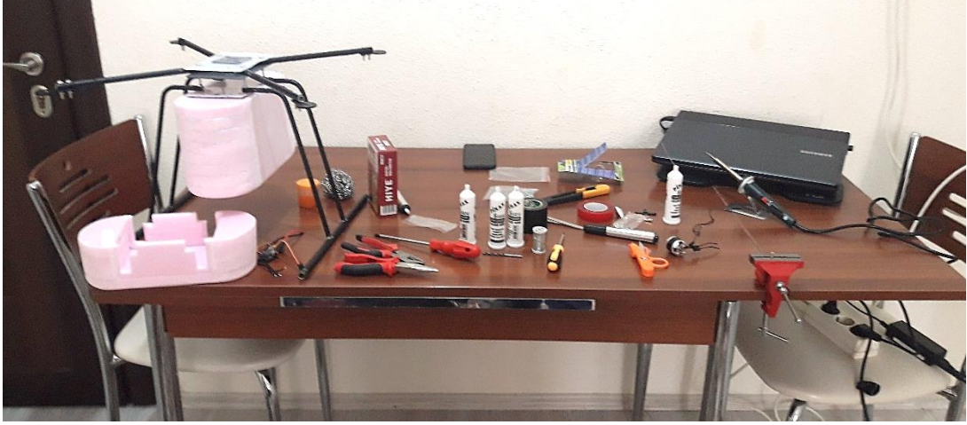
Şekil 50. Karbon fiber kaplama yapılan ana iskelet, motor bağlantı plakaları, dış kaplama olan sıkıştırılmış köpük ve elektronik bağlantı için gerekli malzemeler
