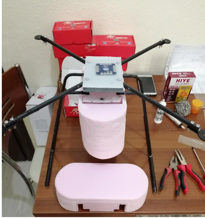
Şekil 52. Güç dağıtım kartının gövdeye montajı
