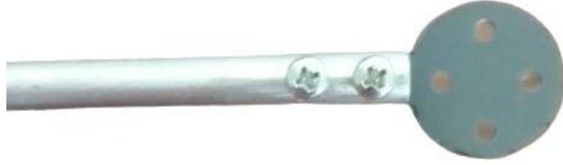
Şekil 44. Motoru tutacak olan parça ile kolun montajı
