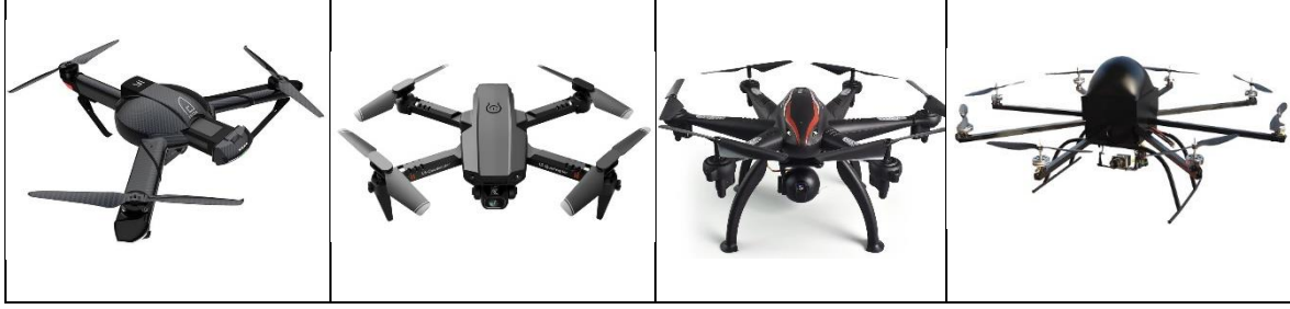
Şekil 5. Sırası ile Tricopter (3 motorlu), Quadcopter (4 motorlu), Hexacopter (6 motorlu), Octocopter (8 motorlu) insansız hava aracı örneği [29 , 30 , 31 , 32]
