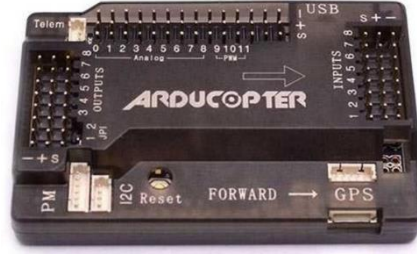
Şekil 9. APM 2.8 Uçuş Kontrol Kartı [23]
