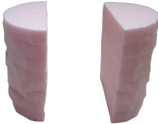
Şekil 24. Strafor köpük alt kapağın yan yüzeylerinin zımparalanmış hali
