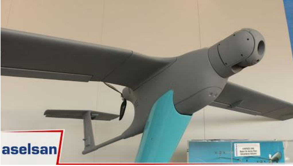
Şekil 1.3. ASELSAN'ın Sabit Kanatlı İHA Sistemi MİUS
